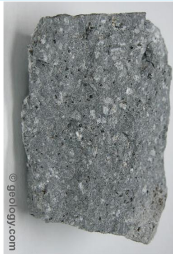
Echantillon et lame mince d'andésite En LPA, les plagioclases, avec des teintes de polarisation gris, montrent souvent des zonations oscillatoires. Les phénocristaux colorés sont les ferro-magnésiens. © C Nicollet
